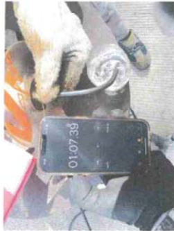
รูปที่ 6 การทดสอบการรั่วซึม / SEAT LEAKAGE TEST
