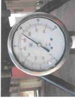
รูปที่ 4 การทดสอบการระบาย / POP TEST
